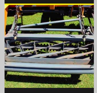
Dispone de un dispositivo de retro afilado. Logrando un mantenimiento óptimo del filo de las cuchillas y molinetes. Siendo este proceso simple, sin necesidad de desarme.
